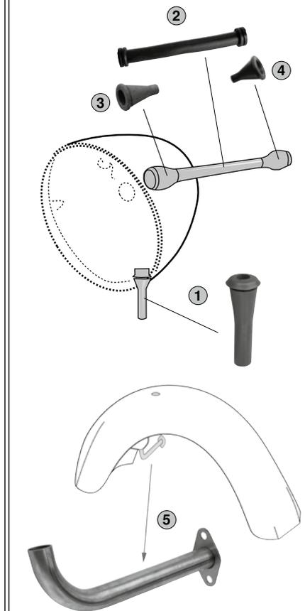
**Dichtung, Scheinwerferglas / Reflektor**
